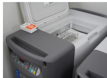
設置イメージ（温度ロガー本体はディープフリーザーの外部に設置し、リード線を庫内に挿入して先端の温度センサで計測）
