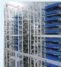
異常検知システムを搭載するマテハン機器 (株)メディパルホールディングス提供
